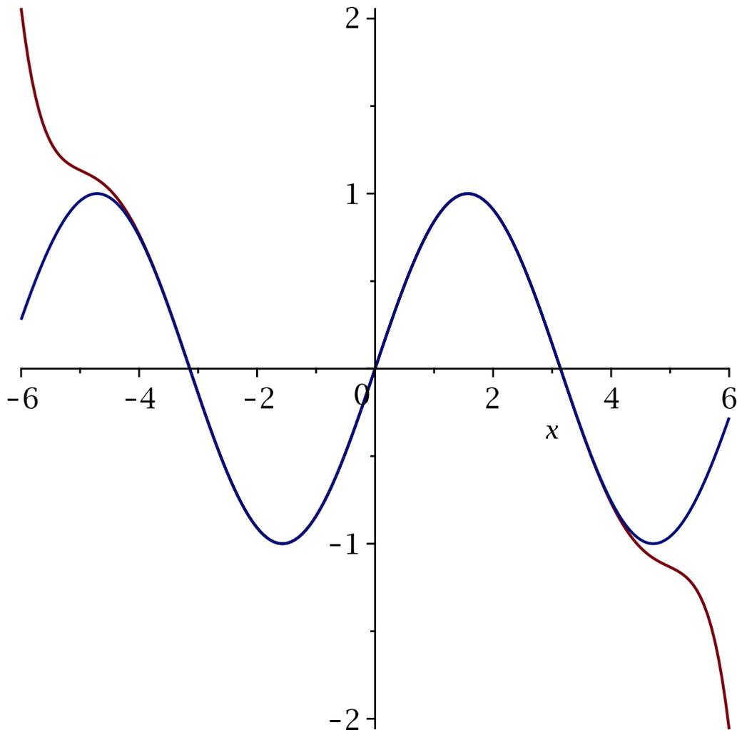
Man sieht, dass die Approximation für die Sinusfunktion immer nur in einem Intervall um den Entwicklungspunkt eine brauchbare Approximation darstellt, dessen Länge mit der Ordnung der Approximation anwächst.
