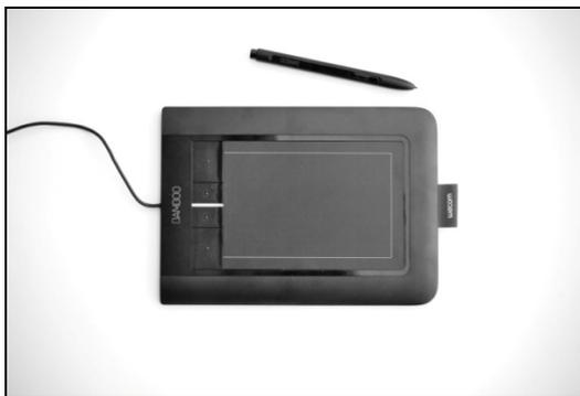
**Abbildung 4:** Das Grafiktablett „Bamboo Pen & Touch“ stellt dem Benutzer die Wahl zwischen einem Eingabestift und den eigenen Fingern als Eingabecontroller frei.
