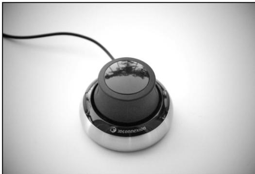
**Abbildung 2:** Die 6D-Maus „SpaceNavigator“ der Fa. 3D Connexion
