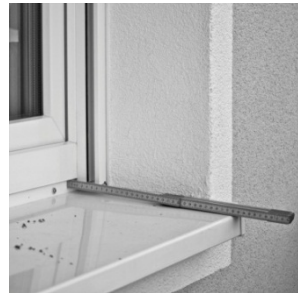
Abb. 2: Zollstock und Maßband dienen zur Vermessung kleinerer Strecken, wie sie bei Fenstern und Türen, Nischen und Vorsprüngen vorkommen – sofern man sie erreichen kann.
