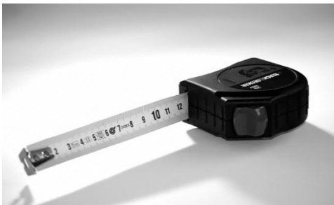
Abb. 2: Zollstock und Maßband dienen zur Vermessung kleinerer Strecken, wie sie bei Fenstern und Türen, Nischen und Vorsprüngen vorkommen – sofern man sie erreichen kann.
