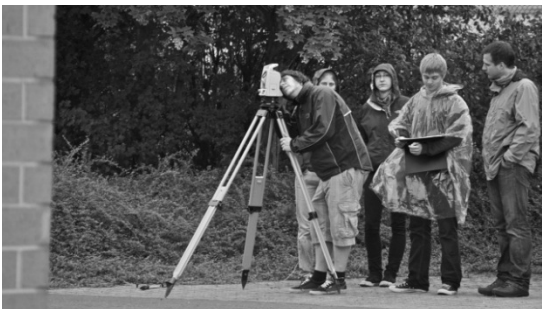
Abb. 3: Große Distanzen und solche, die nur schlecht oder gar nicht mit herkömmlichen Messlaten oder -bändern erreichbar sind, lassen sich mit einem modernen Tachymeter messen.
