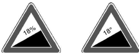
Abb. 6: Steigung und Steigungswinkel
