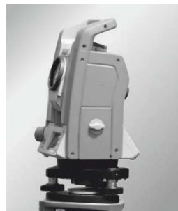
Abb. 3: Große Distanzen und solche, die nur schlecht oder gar nicht mit herkömmlichen Messlaten oder -bändern erreichbar sind, lassen sich mit einem modernen Tachymeter messen.
