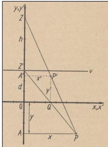
Abbildung 3 Abbildungsgleichung (aus: Wolff 1955)
