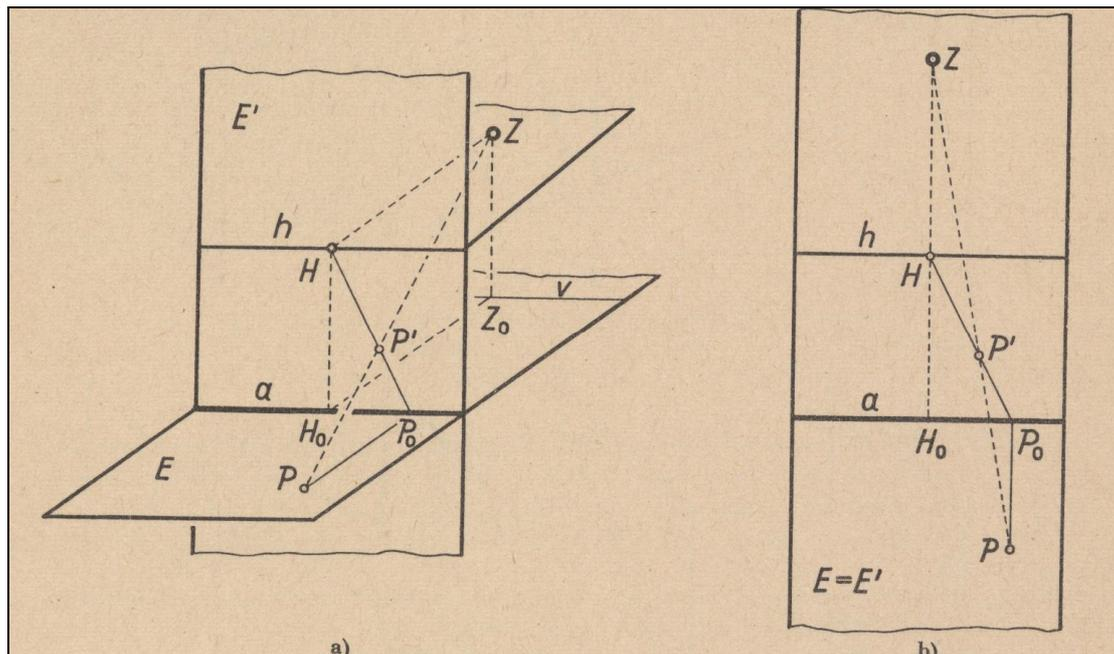
Abbildung 2 Übergang von der Zentralprojektion zur Zentralkollineation (aus: Wolff 1955)
